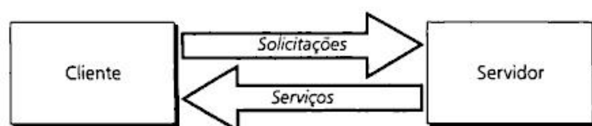
Figura 3.7 O modelo cliente-servidor.
