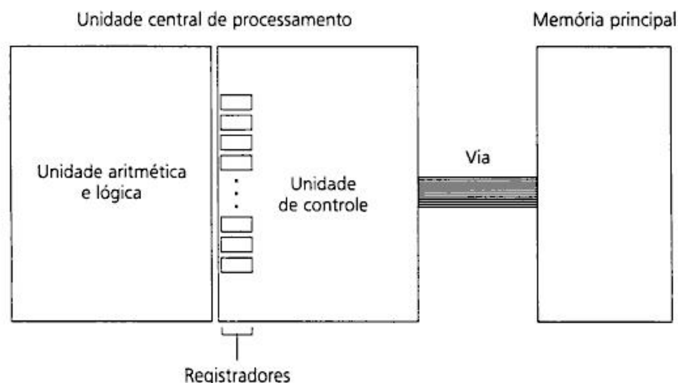
Figura 2.1 UCP e memória principal ligadas por uma via.
