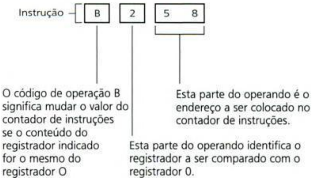
Figura 2.9 Decodificação da instrução B258.
