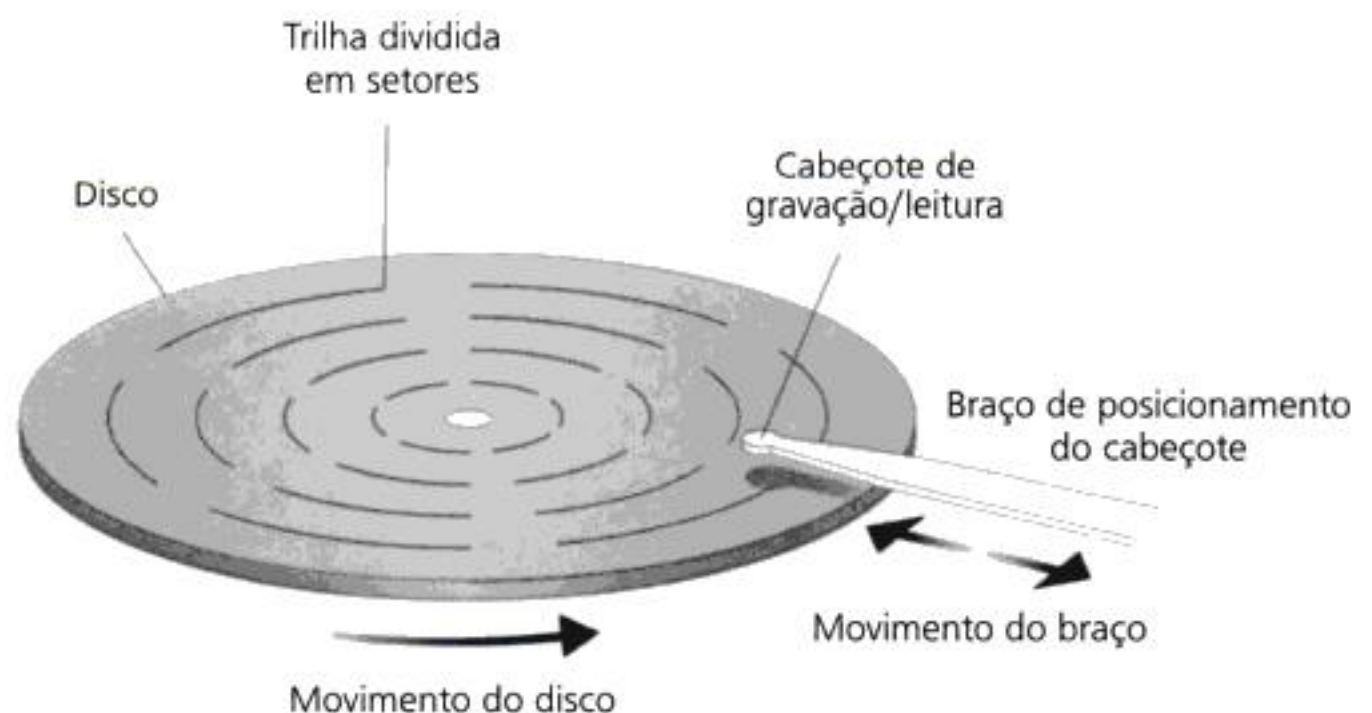
Figura 1.9 Um sistema de armazenamento em disco.
